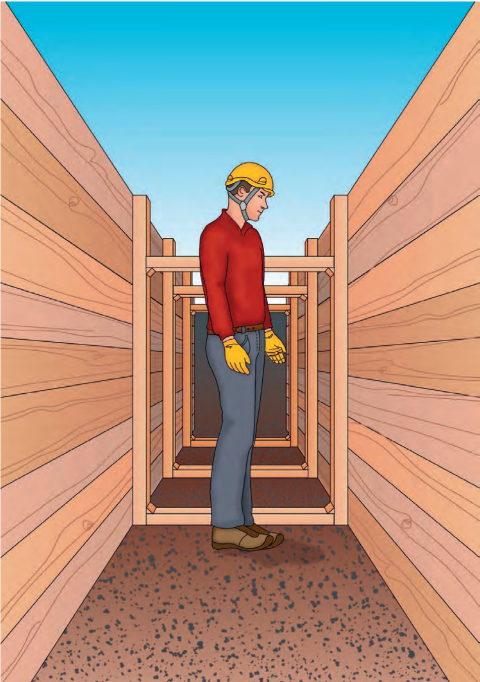
Figura 1 - Sistema realizzato totalmente in legno
