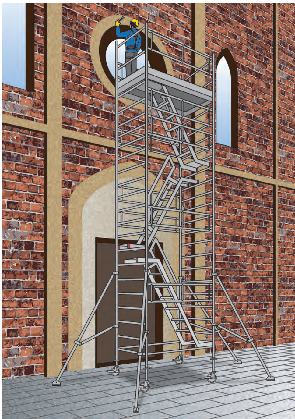
Figura 2 - Trabattello con scala a pioli inclinata
