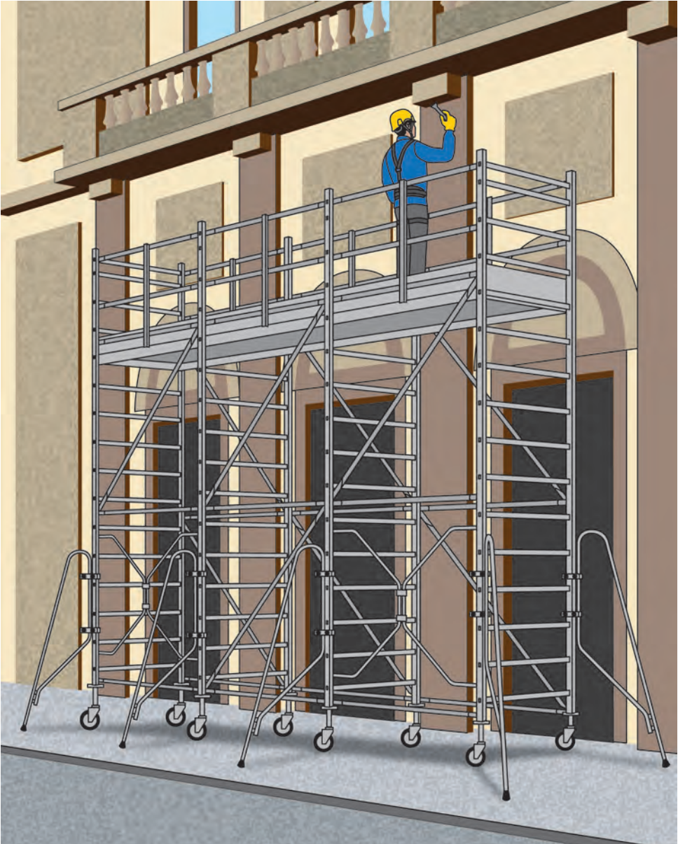
Figura 5 - Utilizzo di un trabattello multiplo (se previsto dal fabbricante)
