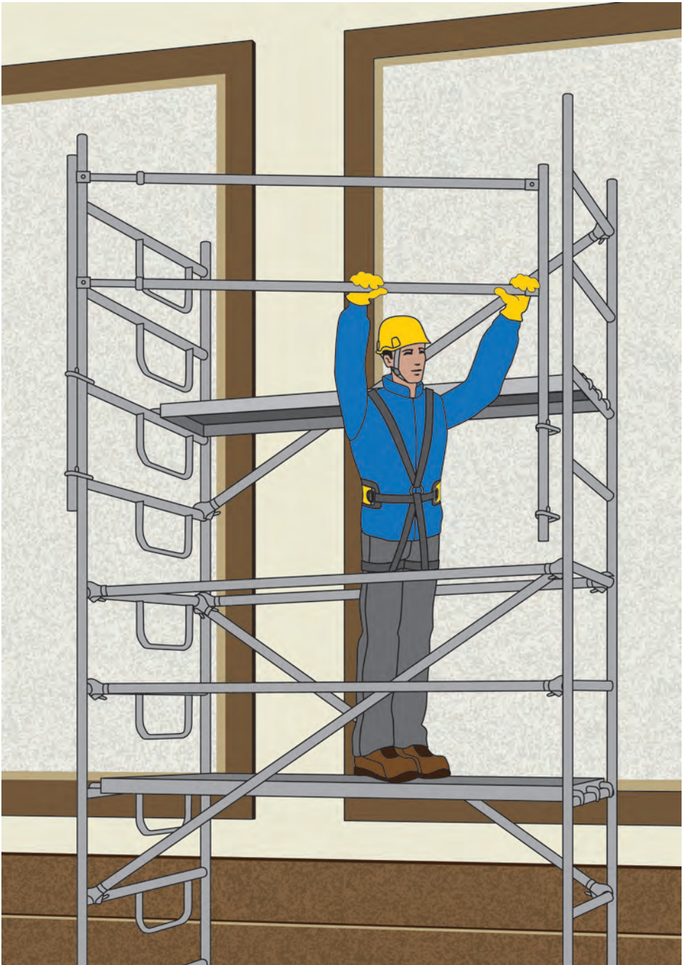
Figura 4 - Trabattello con montaggio dal basso
